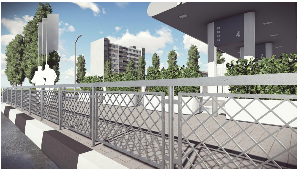
Ограждение пешеходной зоны от проезжей части
